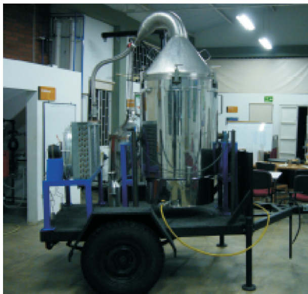
Figura 6. Equipo de extracción de aceites esenciales móvil diseñado en CENIVAM.
